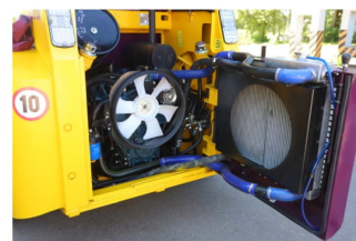
Открываемая задняя дверь капота с радиатором
