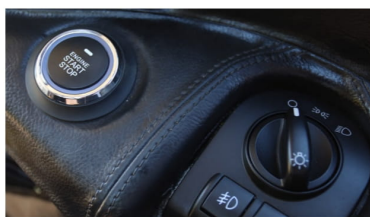
Кнопка запуска ДВС – старт/стоп с иммобилайзером
