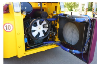
Открываемая задняя дверь капота с радиатором
