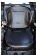
Эргономичное сиденье оператора с регулировкой по росту и массе оператора и амортизацией
