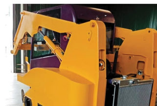
Применение новой двухкомпонентной более стойкой краски (грунт и эмаль – для всех элементов машины)
