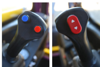
Джойстики с полностью гидравлическим управлением (с кнопкой управления активной навеской)
