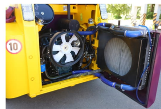
Открываемая задняя дверь капота с радиатором
