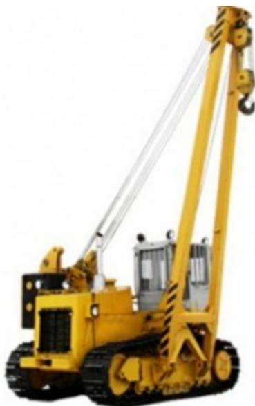
Кран-трубоукладчик ТГ-301 предназначен для укладки труб в траншею и других погрузочно-разгрузочных работ.
